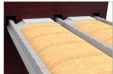
Les Peristen L se posent en rive de plancher, entre le mur et la première poutrelle. Ils doivent impérativement être étayés depuis la pose jusqu'au durcissement complet de la table de compression.
